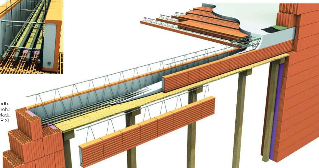
Príklad výstuže prekladu Porotherm KP XL
